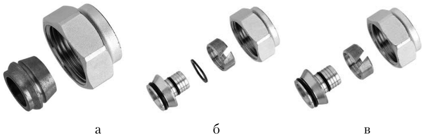
Рис. 32. Фітинги Данфосс для труб: а — сталевих і мідних, б — PEX-Al-PEX, в — VPE/PEX
