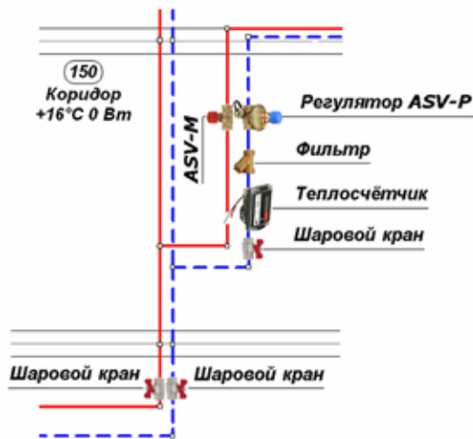
Узел присоединения квартирной приборной ветки с ASV-P
