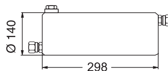
Охладитель импульса давления V2
