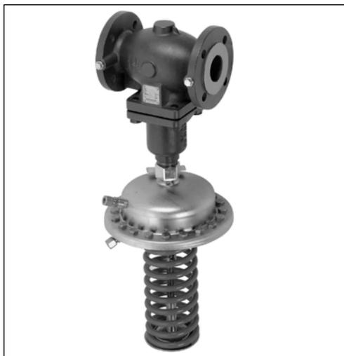
Регулятор AFD является автоматическим редуцирующим клапаном для использования его в системах централизованного теплоснабжения. При повышении давления после регулятора (по ходу движения теплоносителя) клапан закрывается.
