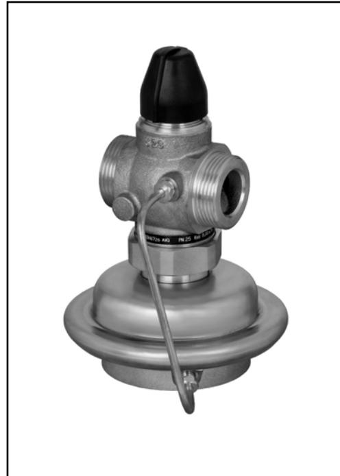
Регулятор AVQ представляет собой автоматический регулятор расхода прямого действия, предназначенный, главным образом, для систем централизованного теплоснабжения. Регулятор ограничивает максимальный расход теплоносителя, закрываясь при превышении установленной максимальной величины расхода.
