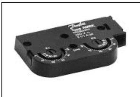
АМЕК предназначен для установки в редукторные электроприводы AMV 323, AMV 423 и AMV 523. Модуль представляет собой панель с 2 двухконтактными концевыми выключателями. Контакты используются для передачи сигналов и могут подстраиваться – каждый отдельно в пределах рабочего диапазона хода штока привода. В электропривод может быть установлено до 3 модулей АМЕК или 1 модуль АМЕК в сочетании с модулем АМЕС или АМЕР.
