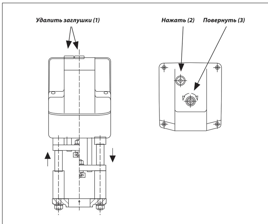
Ручное позиционирование производится с помощью 8-мм шестигранного торцевого ключа (в комплект поставки не входит) поворотом его до нужного положения. При этом следует проверить правильность направления вращения шпинделя. Позиционирование выполняется в следующей последовательности:
