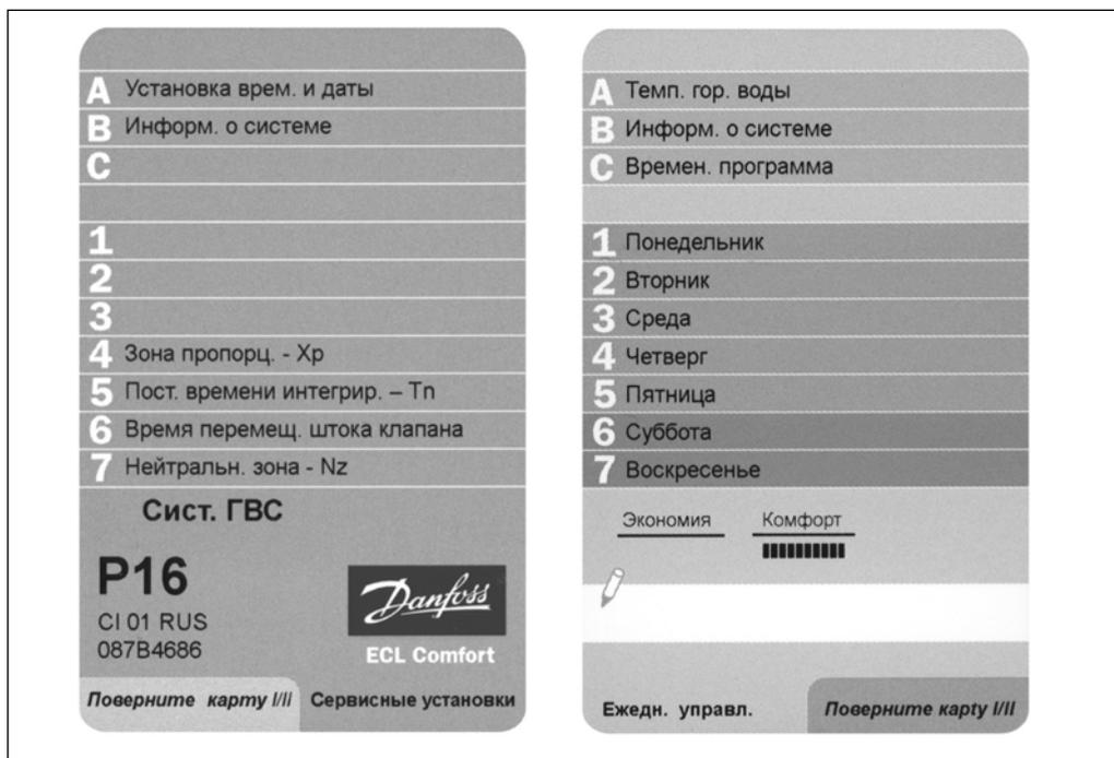
Информационная карта P16 предназначена для облегчения настройки электронного регулятора ECL Comfort 200 в технологических схемах систем горячего водоснабжения, проиллюстрированных на нижеприведенных рисунках. Переключение регулятора на работу с картой P16 осуществляется с помощью кнопок. После этого регулятор будет поддерживать постоянную температуру воды, подаваемой в систему горячего водоснабжения. Регулятор, настроенный на работу с картой P16, кроме функций регулирования, позволяет:
