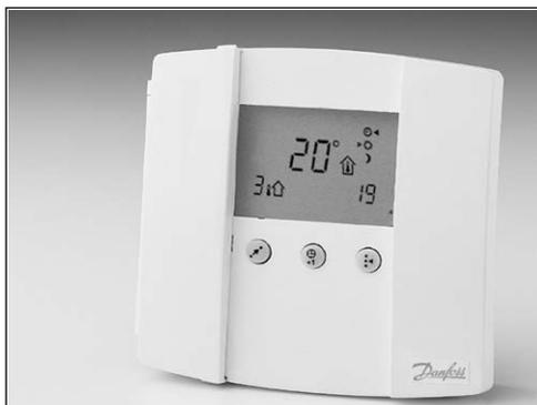
Комнатная панель ECA 60 предназначена для регулирования и коррекции температуры в помещении при работе совместно с регуляторами ECL Comfort 200 и 300. Она подключается к электронному регулятору ECL Comfort с помощью двухпроводной шины и запитывается от электронного регулятора.
