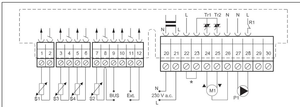
\* Клеммы для предохранительного термостата
