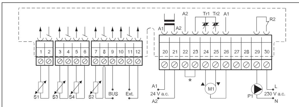
\* Клеммы для предохранительного термостата
