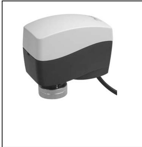
AMI 140 - это 2-позиционный привод с 3-проводным подключением, используемый с клапанами АВ-QM (DN 10-32) и VZ, VZL, VRBZ. Привод можно использовать для регулирования мощности фанкойлов, небольших теплообменников нагрева или охлаждения воздуха и зонирования систем, где теплоносителем или охлаждающей жидкостью является вода. Заводские настройки привода:
