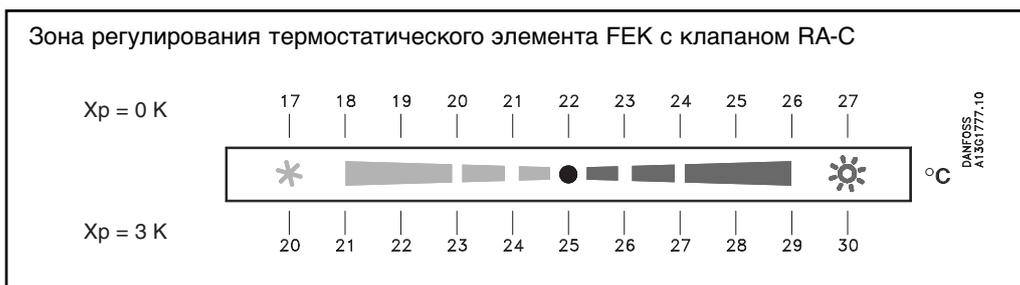
Установка регулятора в голубую зону означает, что задается значение ниже комфортной температуры, т. е. клапан открывается при температуре ниже заданной на заводе и приблизительно равной 22 °С. Установка регулятора в красную зону означает, что задается значение выше комфортной температуры. В этом случае клапан открывается при температуре выше заданной на заводе и приблизительно равной 22 °С.
