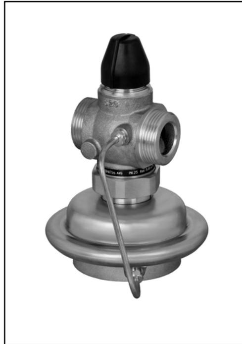
Регулятор представляет собой автоматический регулятор расхода прямого действия, предназначенный, главным образом, для систем централизованного теплоснабжения. Регулятор ограничивает максимальный расход теплоносителя, закрываясь при превышении установленной максимальной величины расхода. Регулятор состоит из регулирующего клапана с настраиваемым ограничителем расхода и привода с одной регулирующей диафрагмой.
