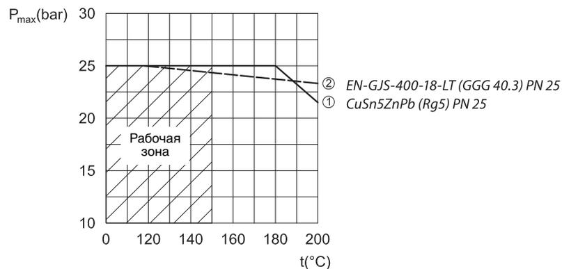
Максимально допустимое рабочее давление как функция температуры рабочей среды (согласно EN 1092-2 и EN 1092-3)
