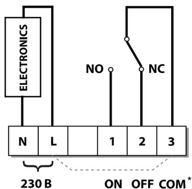
\*При необходимости установить перемычку между клеммами L и COM/3.
