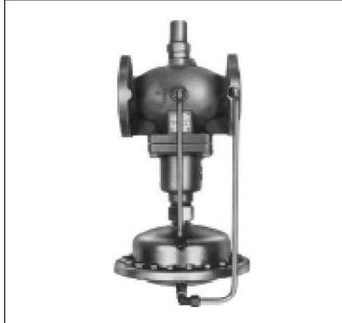
Регулятор AFQ является автоматическим регулятором постоянства расхода и предназначен для применения в системах централизованного теплоснабжения. При увеличении расхода сверх заданного регулятор закрывает клапан. Регулятор состоит из регулирующего фланцевого клапана с дроссельным клапаном для задания расхода и регулирующего элемента с диафрагмой.
