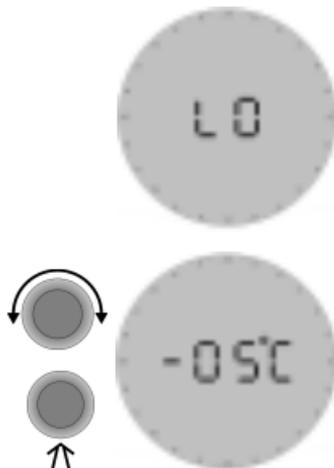
Режим (**OFFS**) позволяет выровнять расхождение в показаниях температуры на индикаторе терморегулятора и комнатном термометре.
