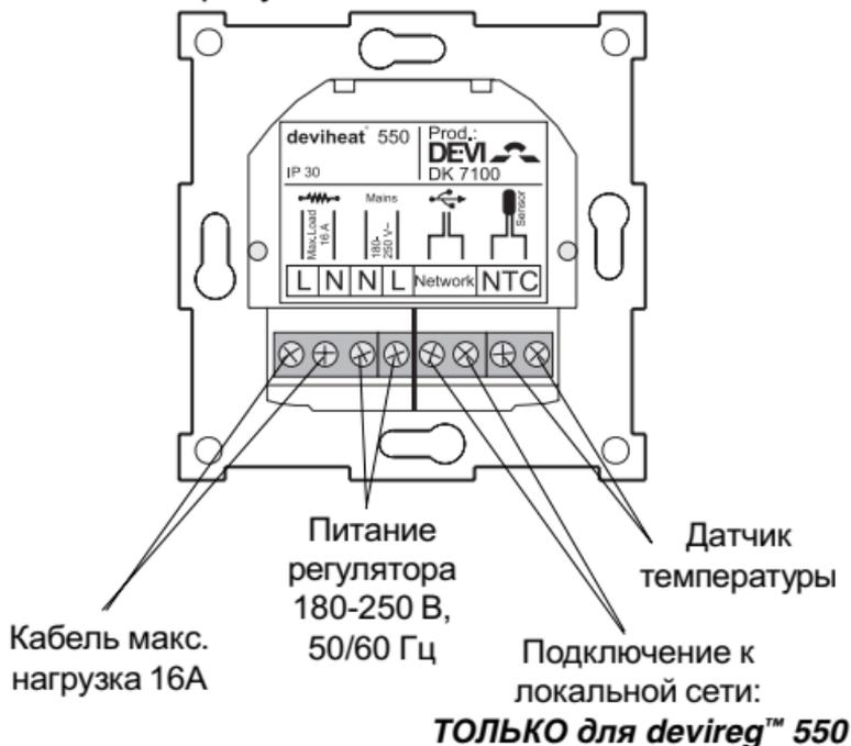
**Внимание!** Терморегулятор **devireg™ 540/550** не имеет специального контакта для подсоединения «земли». Вывод экранирующей оплетки кабеля должен соединяться с проводом «земля» питающей сети с помощью дополнительного контакта вне терморегулятора.
