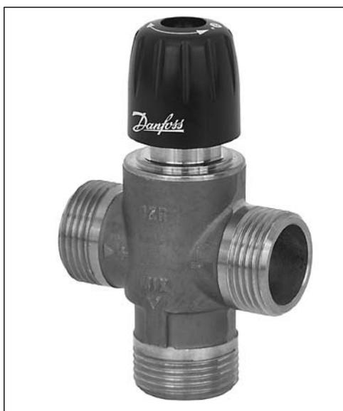
TVM-H – термостатический смесительный клапан прямого действия, который ограничивает и поддерживает на постоянном уровне температуру воды перед распределительным коллектором системы напольного отопления или перед водоразборными точками системы ГВС. Термостатический клапан обеспечивает постоянную температуру смешанной воды на выходе из клапана. Клапан TVM-H используют преимущественно в системах отопления.
