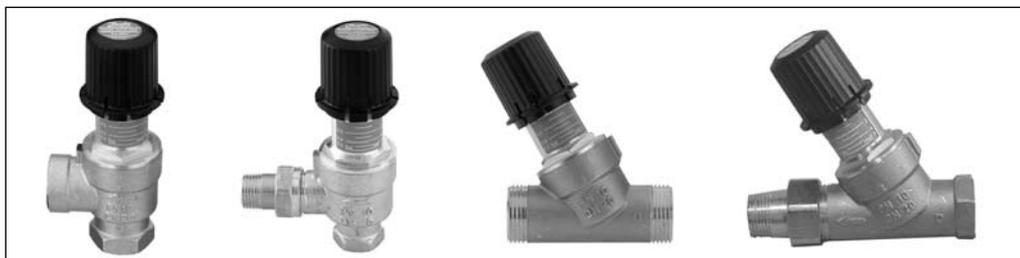
Автоматический перепускной клапан AVDO используют главным образом для обеспечения минимальной циркуляции теплоносителя, например, в газовом водонагревателе низкой производительности, либо для поддержания требуемого перепада давления в системе.
