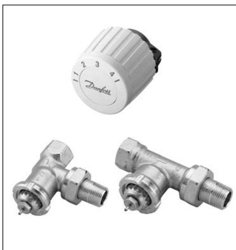
Ограничитель температуры обратной воды FJVR автоматически поддерживает на заданном уровне температуру теплоносителя после радиатора, конвектора или циркуляционного контура системы напольного отопления.
